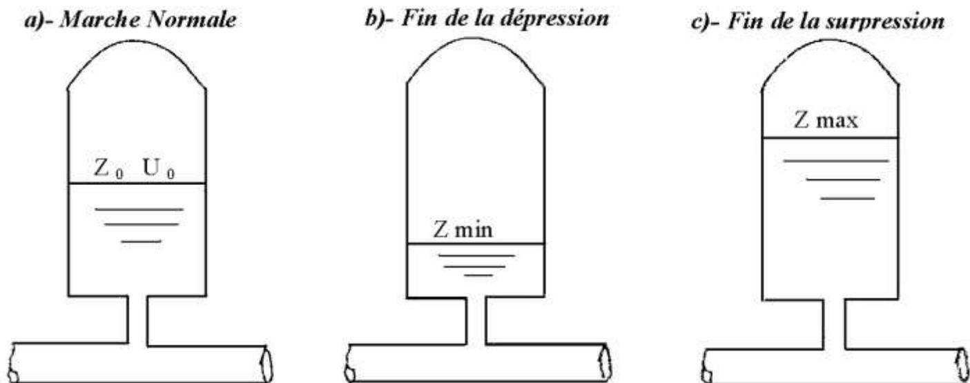
Figure (VI-8): Réservoir d'air
