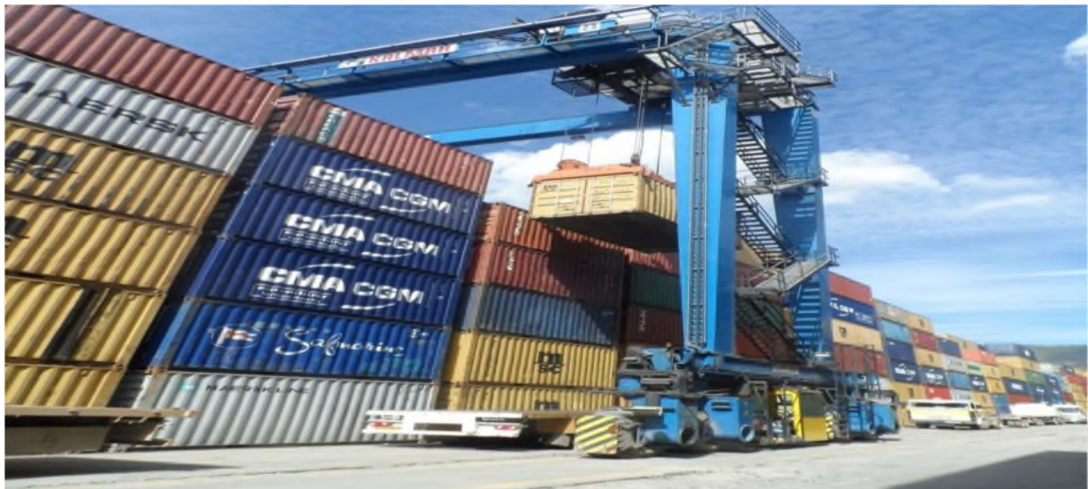
Figure n°17 : Portiques gerbeuses sur pneus
