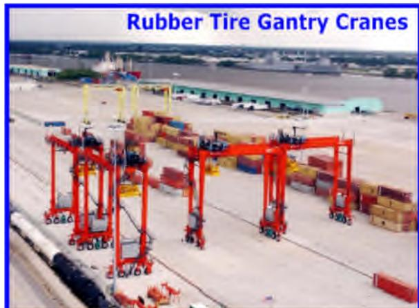
**Figure 7:** Portique mobile sur Pneu
