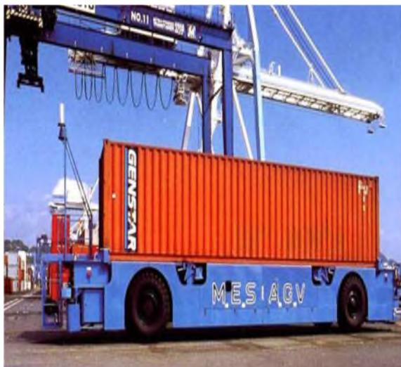
**Figure 17 :** Véhicule à guidage automatique.
