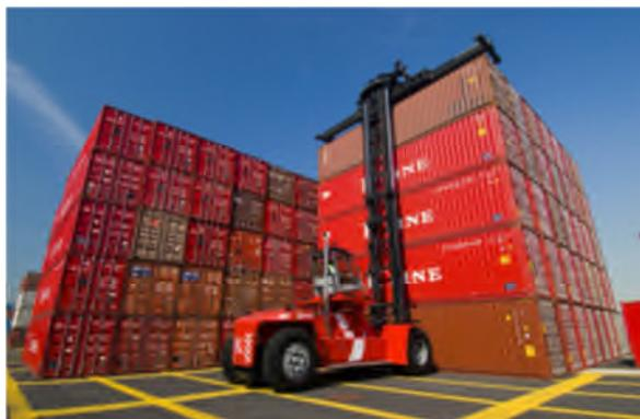
**Figure 5 :** Chariot élévateur prise frontale
