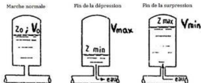
Figure VII.2 : Mode de fonctionnement d'un réservoir d'air. (BOUCHAIB.S, 2017)
