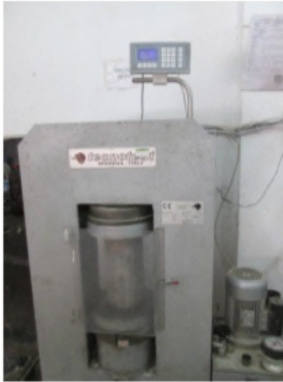
Figure IV.5: Essai de compression d'une éprouvette cylindrique de béton[4].
