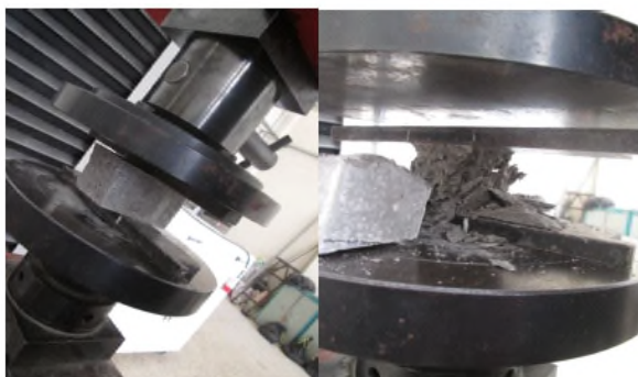
Figure IV.2 : Essai de résistance à la compression[4].
