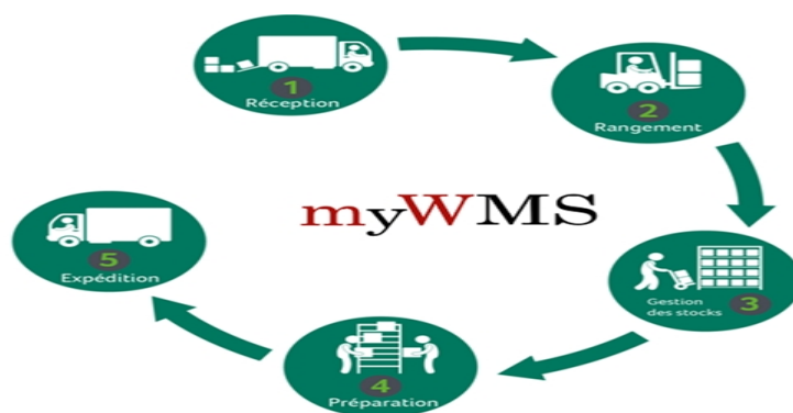
FIGURE 1.8 – Fonctionnement d'un logiciel WMS. [22]
