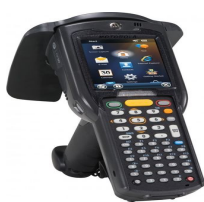
FIGURE 3.10 – Exemple d'un lecteur RFID mobile.[10]
