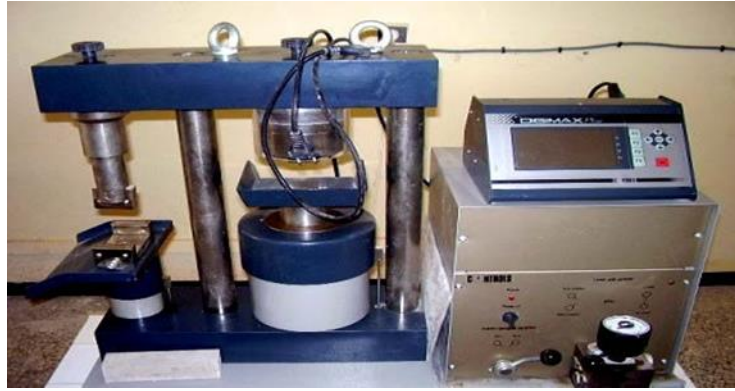
Figure II.5 : Machine de compression et flexion sur les ciments (Control) type 65-113M1.
