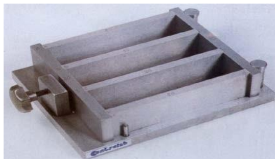
Figure II.2 : Les moules utilisés pour la préparation des matrices cimentaires.
