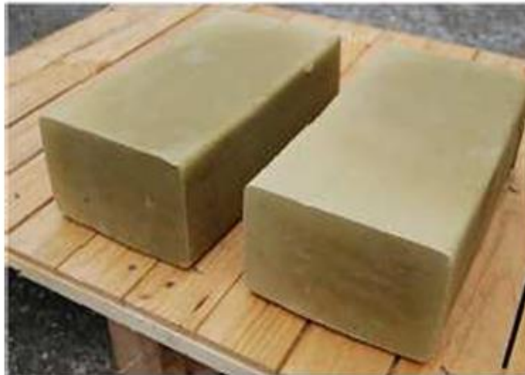
Figure 3.1 : Briques non cuites obtenues à partir des margines (Amrani et Bendidi, 2014)
