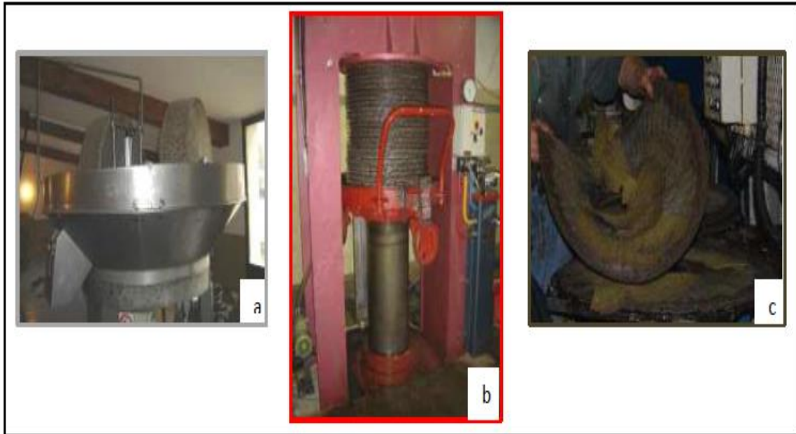
Figure 1. 6 : Meule de granit à deux roues (a), presse hydraulique (b), scourtins contenant les grignons secs à la sortie de la presse (c) (Veillet, 2010)
