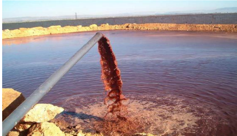
Figure 3.3: Bassin d'évaporation naturelle des margines (Amrani et Bendidi, 2014)
