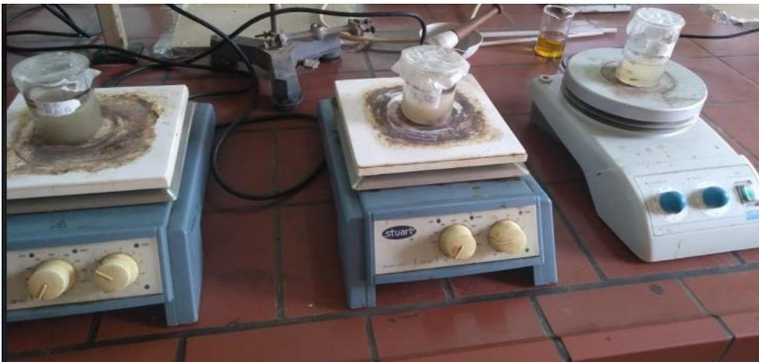
**Figure 23:** Photographie des échantillons immergés dans l'eau distillée durant le test d'absorption.
