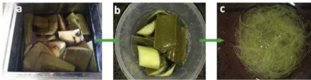
Figure I.12: rouissage à l'eau des fibres d'Aloe Vera [41].
