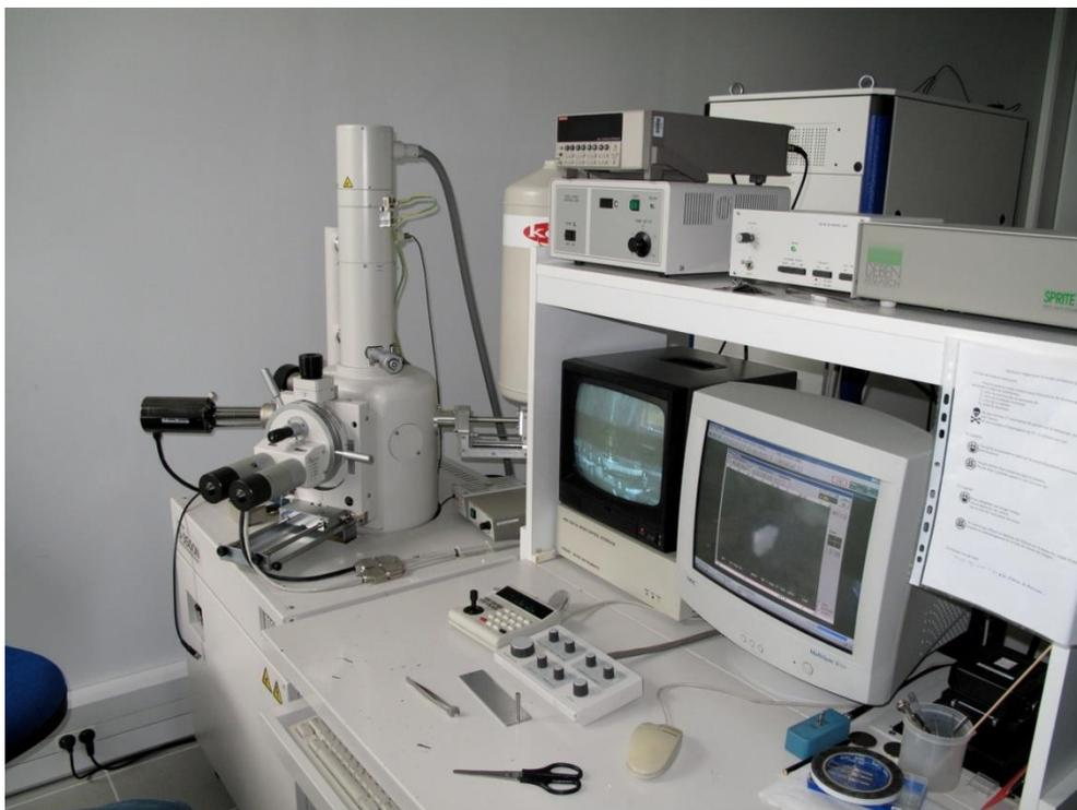
**Figure 4.4 :** Image du système de lithographie utilisé [88].
