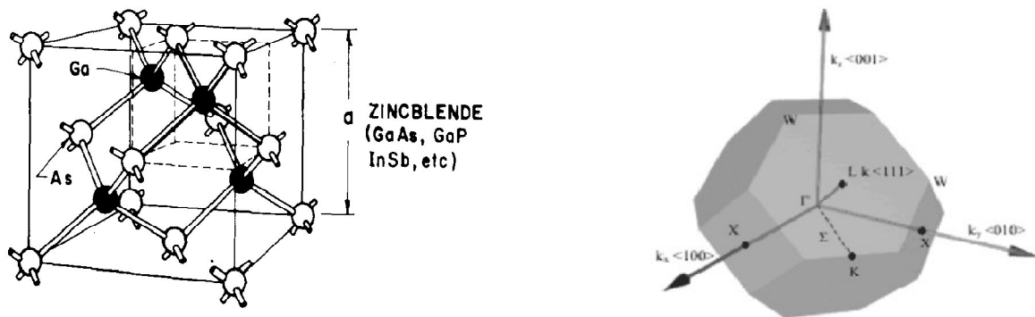
Figure II.1 : (a) structure cristalline du GaAs, (b) la première zone de Brillouin [5] [24].
