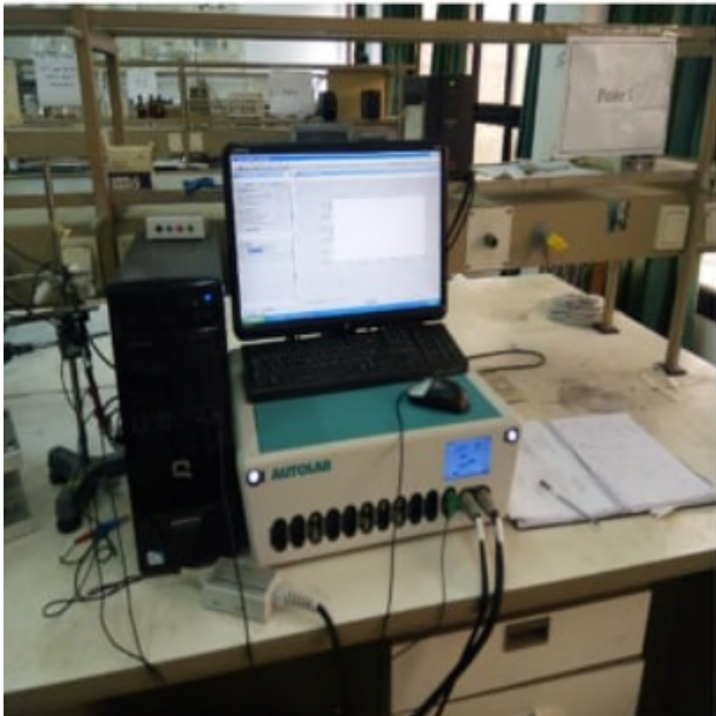
Figure.II.5 : Dispositif expérimentales AUTOLAB de mesure de l'impédance électrochimique.
