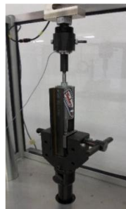
Figure 2.5- Prototype n°3 du convertisseur électromagnétique intégré dans le corps de l'amortisseur
