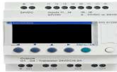
Figure II.4 : Automate modulaire (Siemens). Figure II.5 : Automate compact (Schneider).
