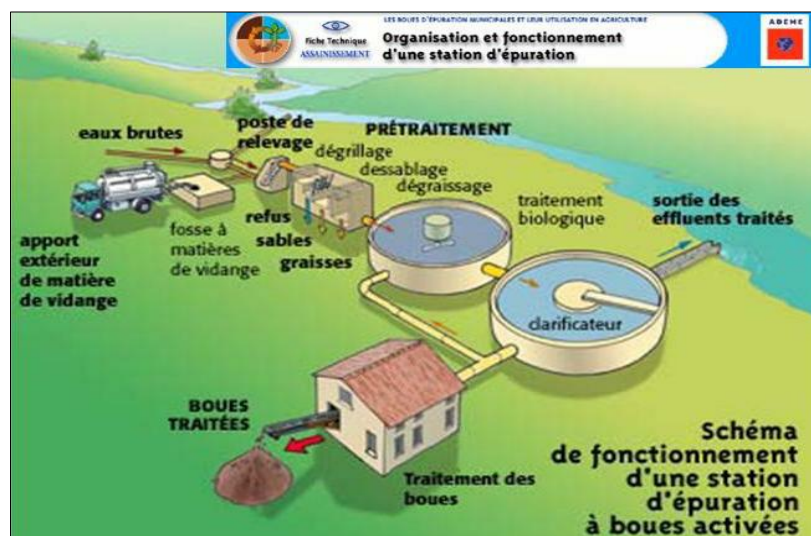
Figure I.3. Schéma de différentes étapes de traitement.
