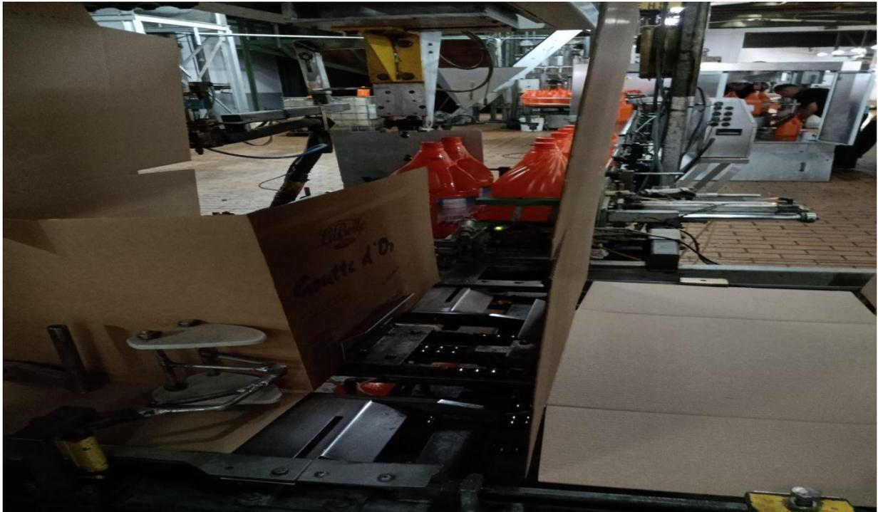
**Figure I.3 :** Pliage vertical des pans
