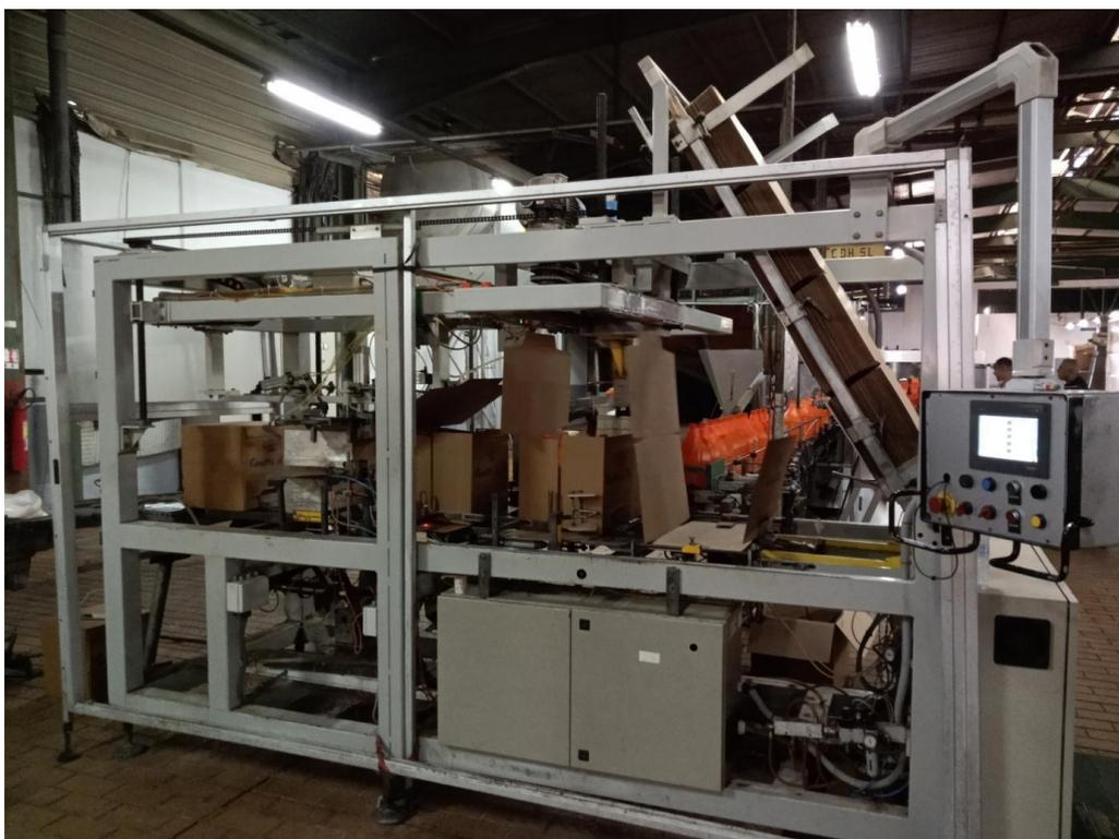
**Figure I.1 :** Encartonneuse automatique
