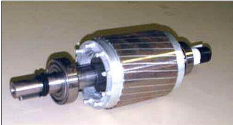
Figure I.1 Rotor d'une machine asynchrone[2]
