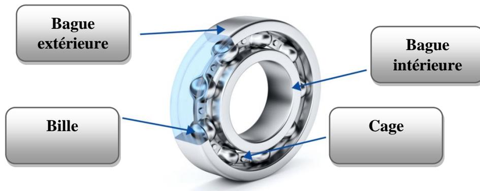
Figure I.3 Schéma d'un roulement à billes [5]
