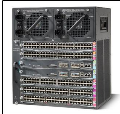
Figure 2.4 : Switch Core/ distributeur.
