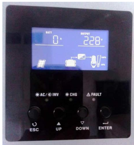
Figure III.15 : Affichage l'écran LCD cas batterie
