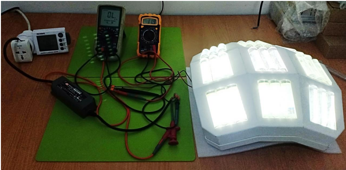
Figure II.17 : Banc d'essai réalisé avec le redresseur
