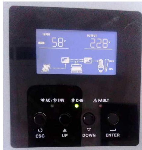
Figure III.13 : Affichage de l'écran LCD dans le cas d'alimentation avec le PV
