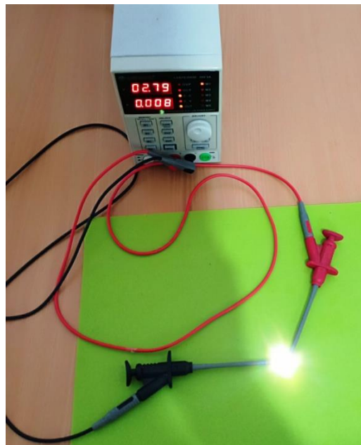
Figure II.4 : Banc d'essai réalisé pour la LED
