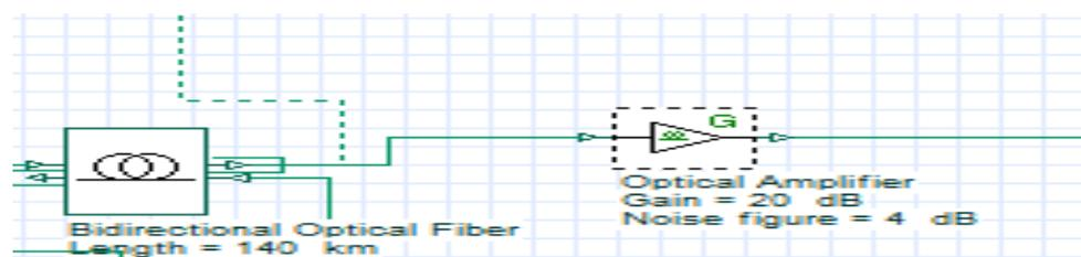
Figure III.20 : amplificateur optique à la sortie de la fibre
