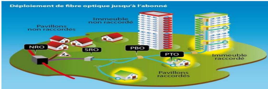
Figure II.15: Chemin de la fibre [17]
