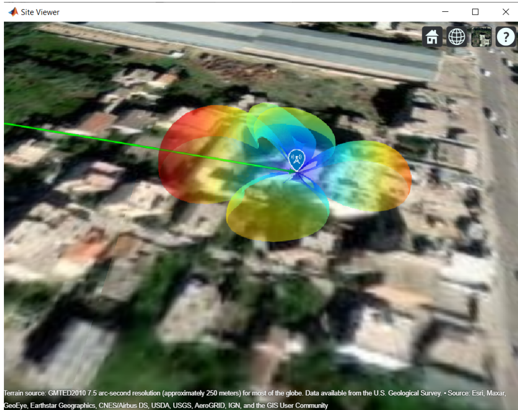
FIGURE 4.3 – Réseau d’antennes 3 par 3 sur le site du récepteur
