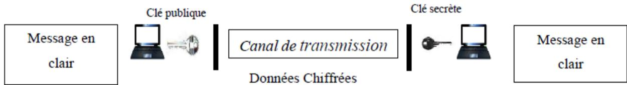
Figure 1.6 : Principe du chiffrement asymétrique.
