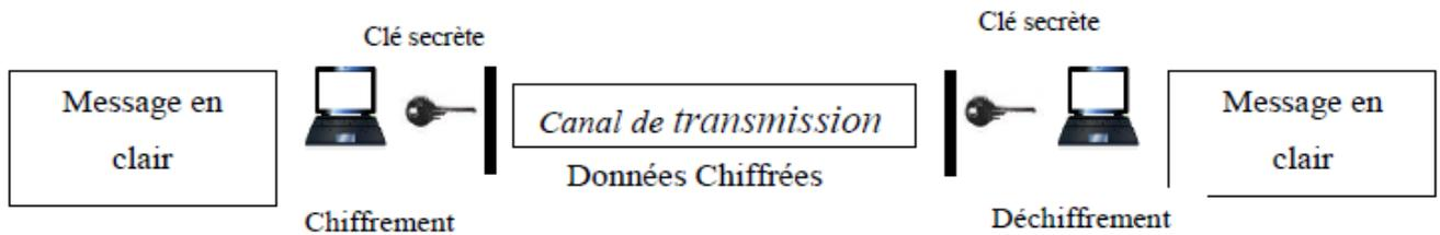
Figure 1.2 : Principe du chiffrement symétrique.
