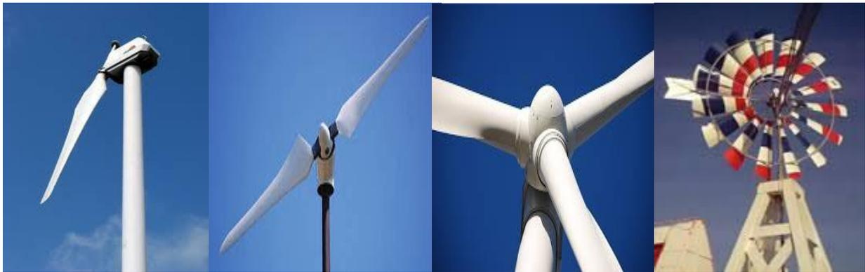
Figure I.7 Éolienne a axe horizontal.
