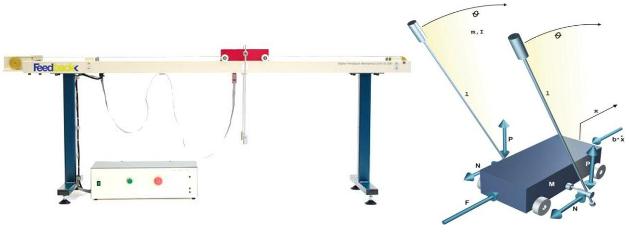
Figure I.2 : Le banc d'essais du pendule inversé (Feedback 33-200)
