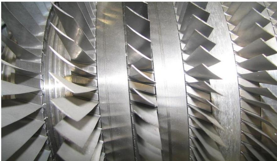
**Figure I.10:** Ailettes et Rotor du compresseur.
