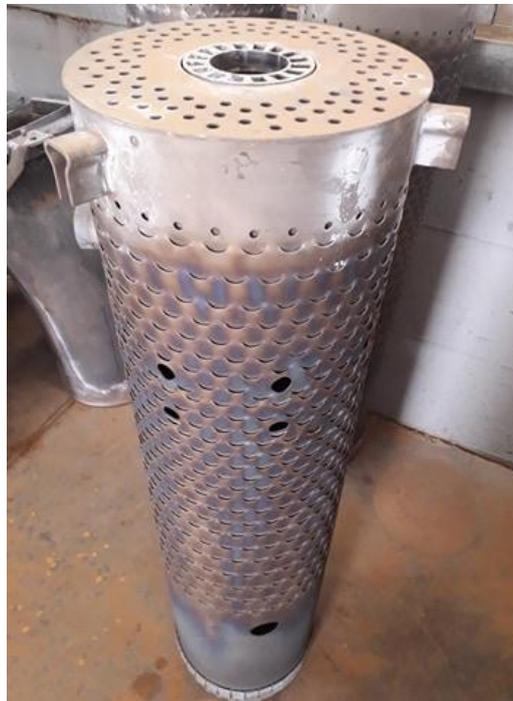
**Figure I.11 :** Chambre de combustion.
