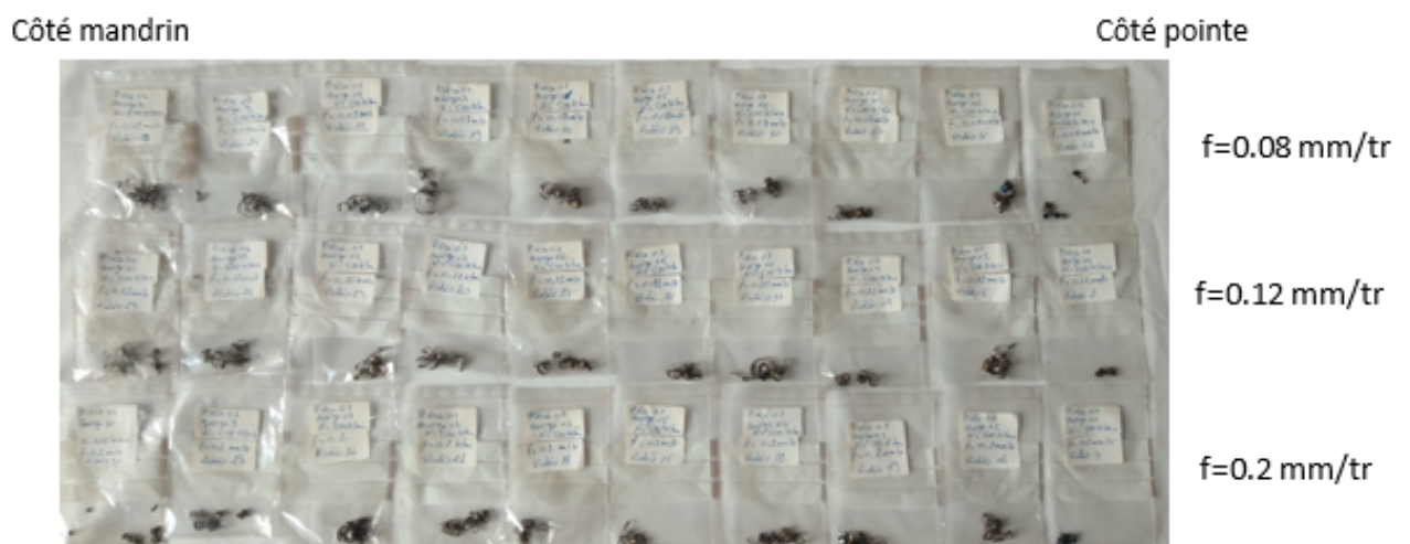
FIGURE 3.14 – Copeaux obtenus pour V_c = 60\text{m/min}
