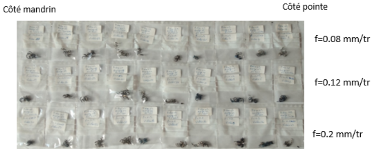
FIGURE 3.15 – Copeaux obtenus pour V_c = 80m/min
