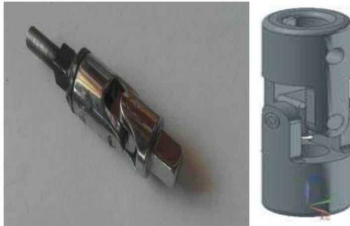
**Figure III.30** Image de l'accouplement par joint de cardan choisi pour la machine.
