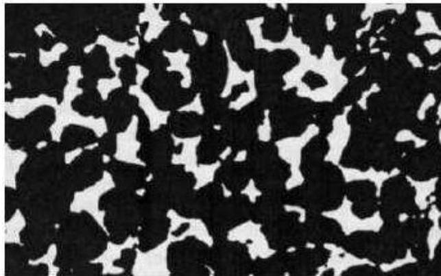
**Figure I.2:** exemple d'une coupe d'un milieu poreux (grès). [4]
