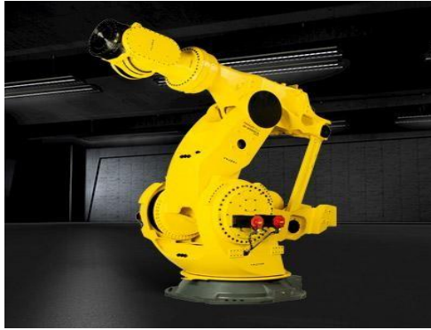
Figure 1.9 Robot Fanuc (anthropomorphe).
