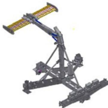
**Figure I.4 :** Hydrolienne à aile battante ou oscillante [1].
