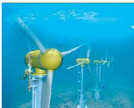
Figure I.2 : Hydrolienne à axe horizontal ou à flux axial [1].
