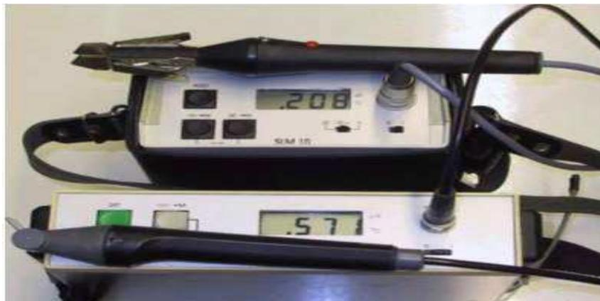
**Fig. II. 1:** Photo d'un conductimètre à sonde mobile
