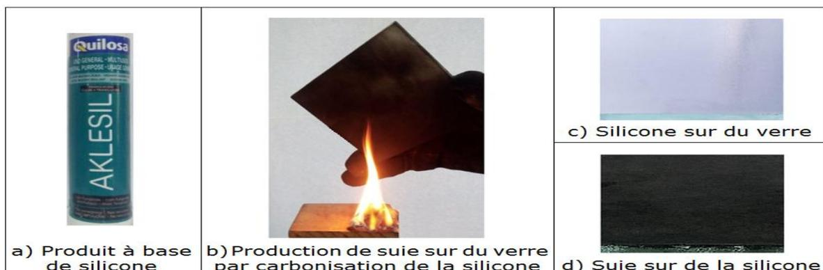
**Fig. I. 10:** Etapes essentielles de fabrication d'un revêtement en suie sur une plaque en verre
