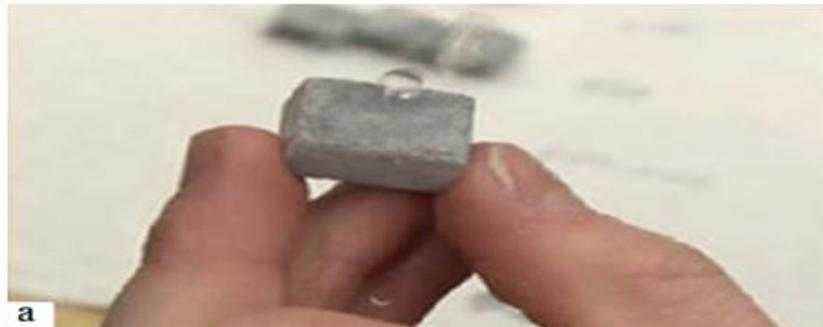
**Fig. I. 9:** Goutte d'eau sur la surface du béton intelligent
