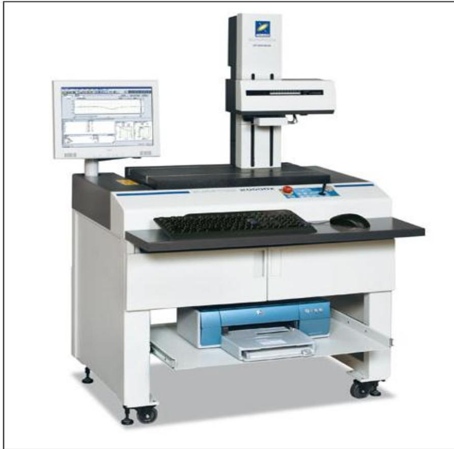
Fig. III. 3: Photo d'un profilomètre du laboratoire de HT de Zittau (Allemagne)
