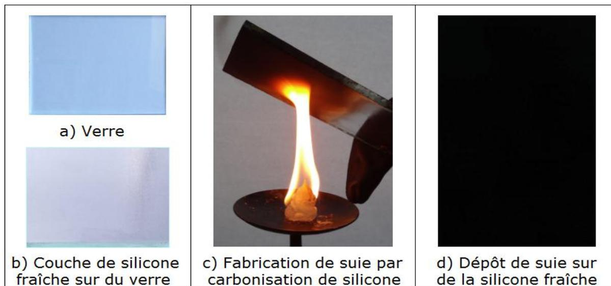
**Fig. III. 1:** Étapes de confection d'une isolation à multicouches superhydrophobes
