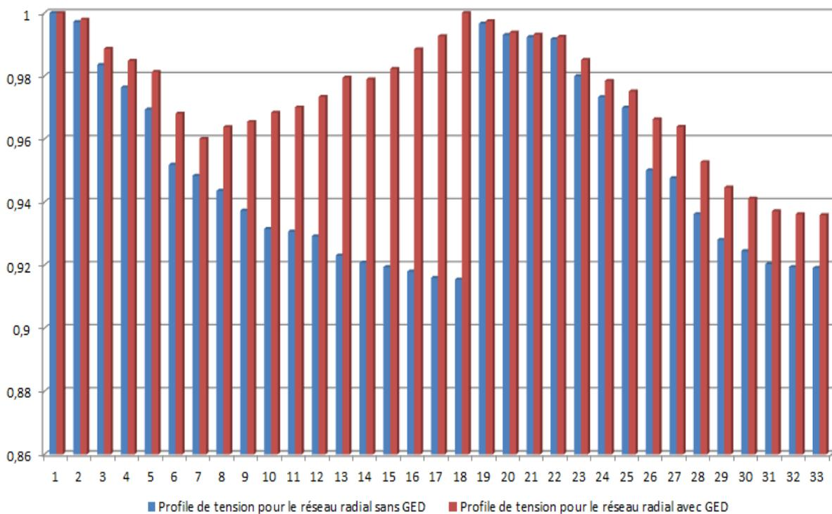
Figure IV. 11: Profile de tension des jeux de barre pour le réseau radial avec DG.
