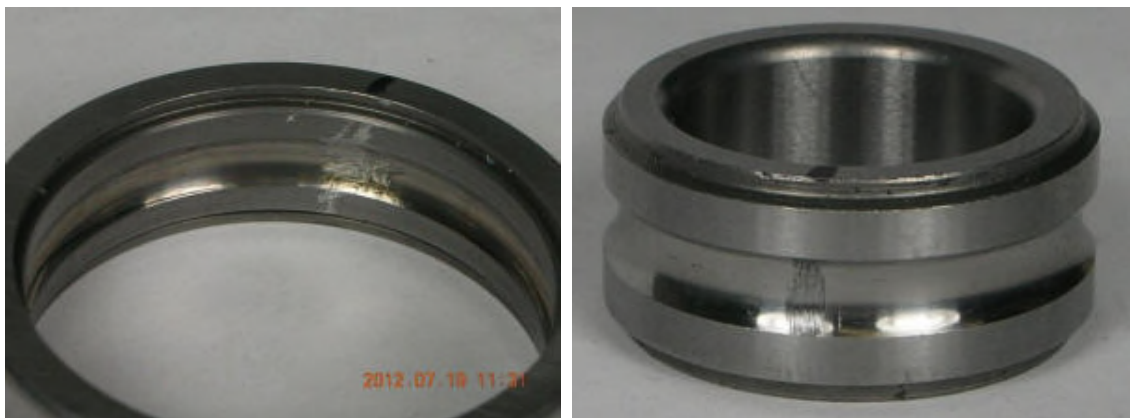
(a) Défaut sur la bague externe
