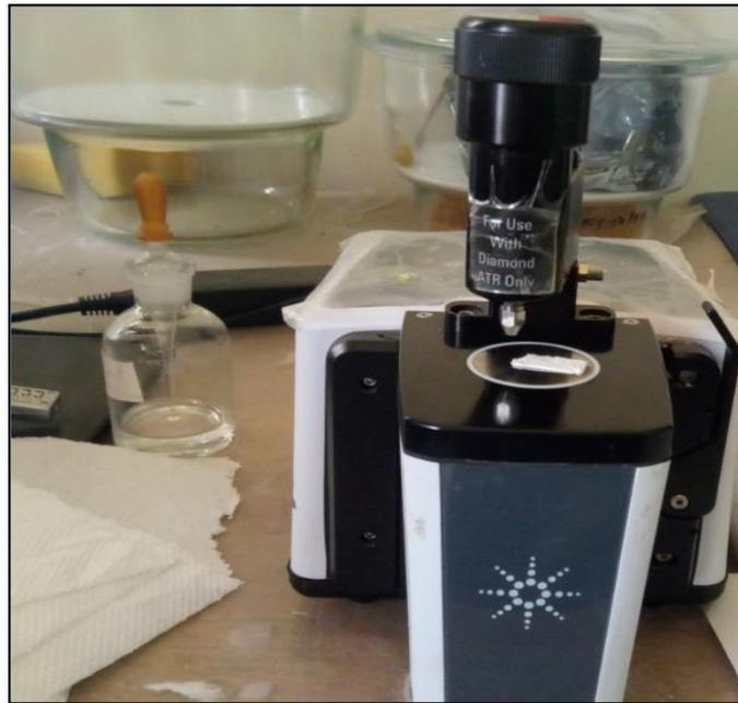
**Figure III- 13 :** Photo du spectrophotomètre IR affinity-1 et le mode ATR.
