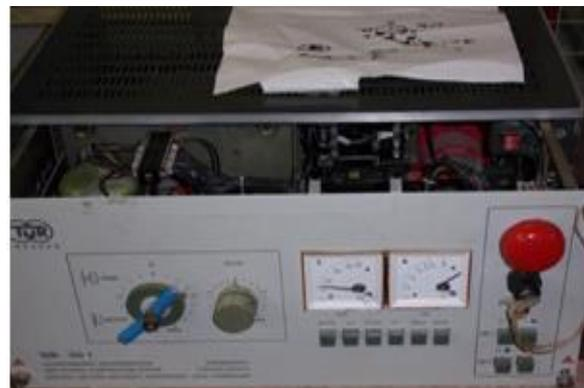
e) : appareil de commande automatique et manuelle de la tension
