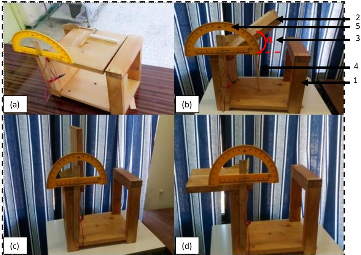
**Figure III- 3** Différentes vues du banc d'essai de mesure de l'angle de contact  $\theta$ .
