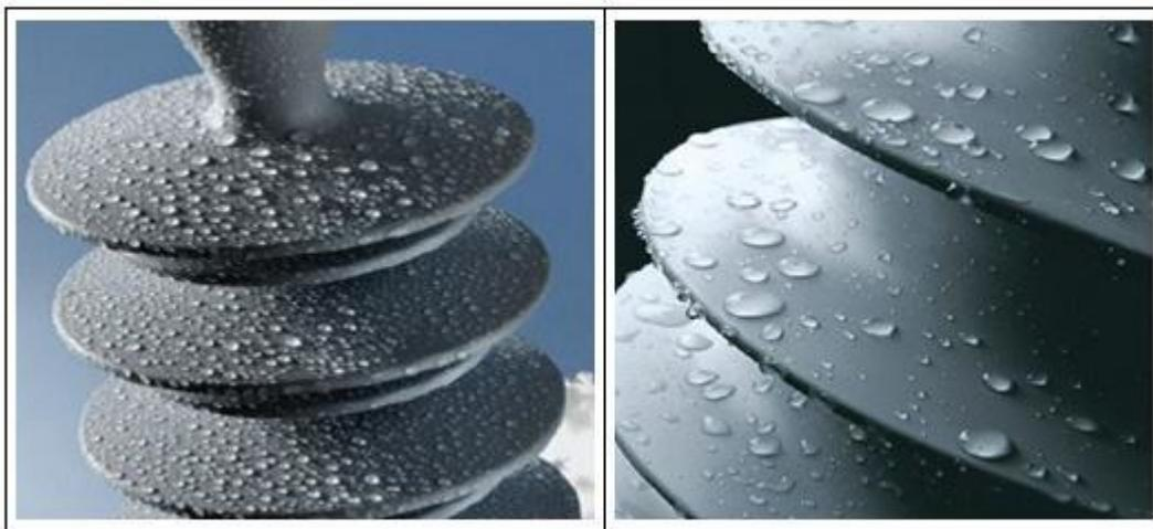
Figure I- 7 : Hydrophobicité d'une surface en silicone.
