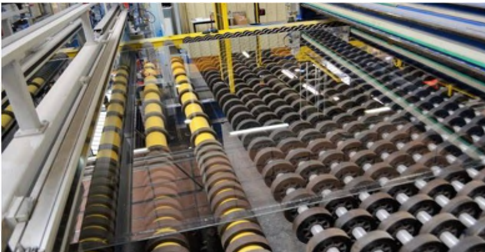
Figure II. 7 : Ligne de découpe longitudinale et horizontale du verre
