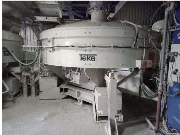
Figure II. 2: Malaxeur de matières premières.
