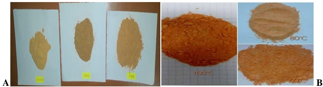
Figure 2 : photographie des poudres de carotte séchées par microonde(A) et par l'étuve (B)
