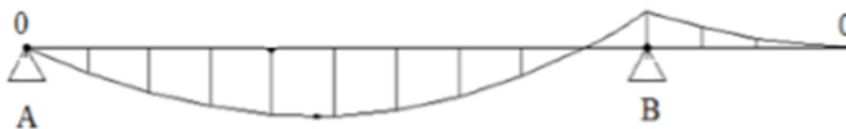
Figure.28. Diagrammes des moments a E.L.S.
