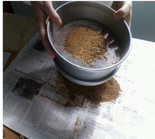
Figure n° 11 : Tamisage de la terre avec un tamis de 2 mm
