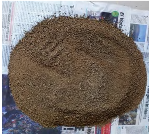
Figure n° 12: La terre fine prête à l'emploi ( \varnothing < 2\text{mm} ).
