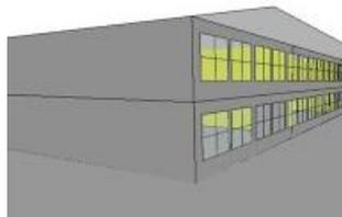
Figure : proposition d'un brise soleil sous forme d'un élément extensible horizontal
