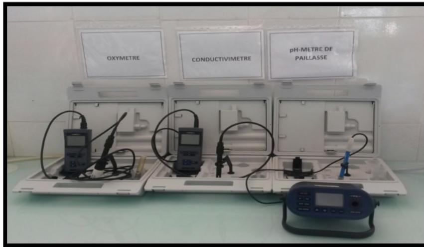
**Figure I.2 :** Equipements de paillasse de mesure de paramètres physiques.
