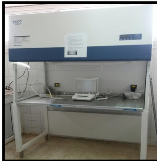
**Figure I.21 :** hotte à flux laminaire
