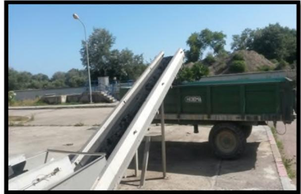
**Figure I.15** : Bloc de déshydratation des boues **Figure I.16** : Boues déshydratées
