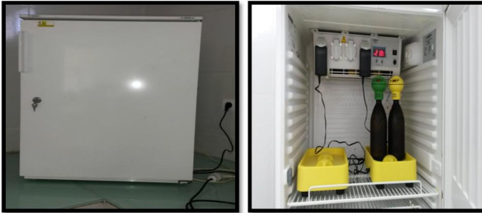
**Figure I.10:** Dispositif de mesure de la DBO<sub>5</sub>.
