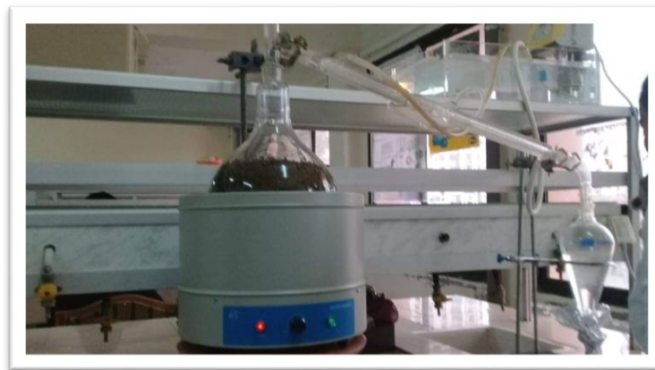
Figure4 : Montage d'extraction par Hydrodistillation.
