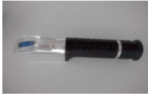
**Figure n°10** : Photographie d'un réfractomètre à main de type Zuzi série 300.
