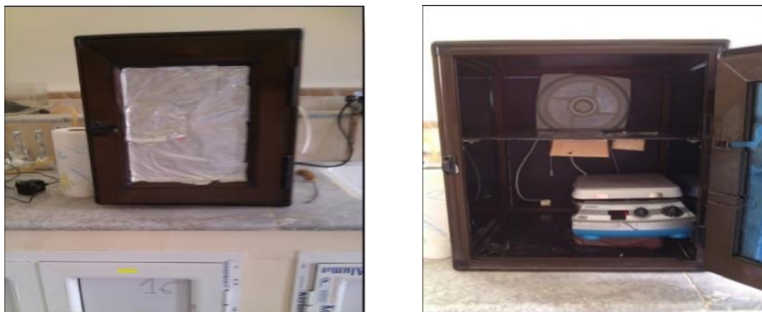
Figure II.8 : Montage utilisé pour le traitement photo-catalytique.
