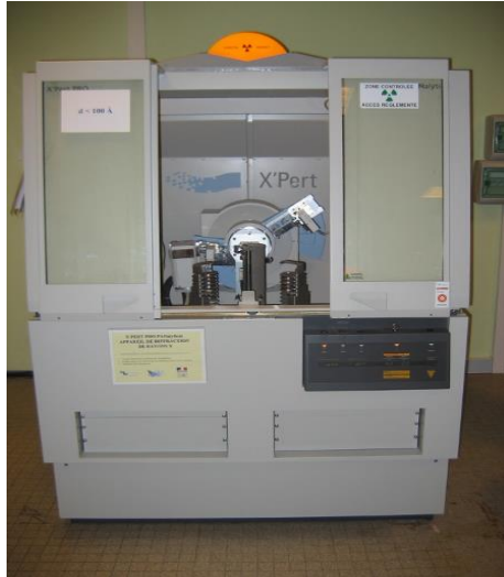
Figure 2.3 :Le diffractomètre utilisé
