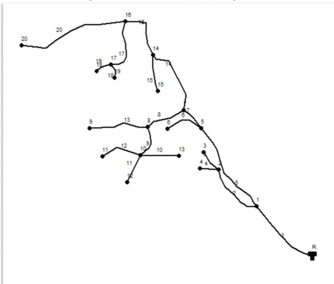
Figure (VII.3) : Schéma d'ossature du réseau de distribution du village Ouled Abdellah.
