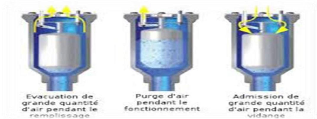
**Figure (V.9) :** Schéma explicatif du fonctionnement d'une ventouse
