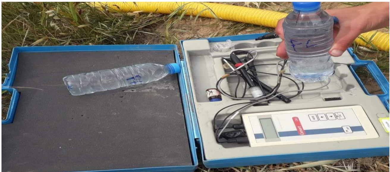
Figure 11: Valise multi paramètre utilisée pour les mesures In Situ. [12]
