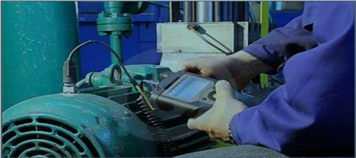
**Figure .III.8.** analyse vibratoire
