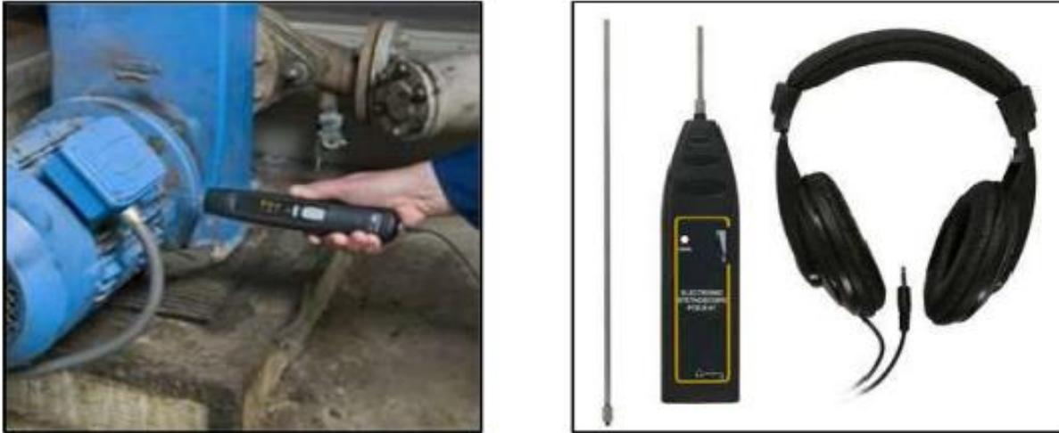
Figure .III.19.Analyse du bruit [22]
