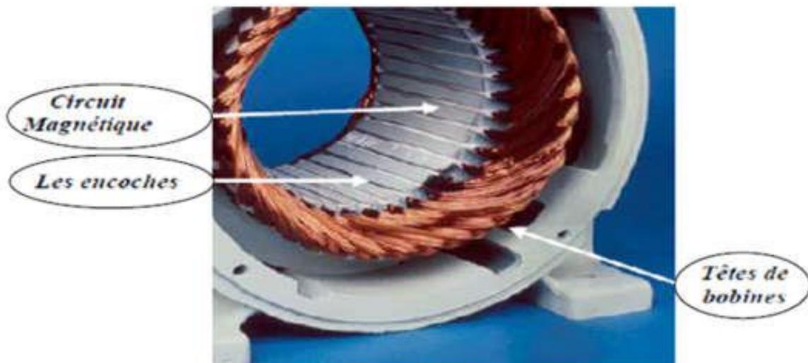
Figure .II.3. Photo du stator d'une machine asynchrone [11]
