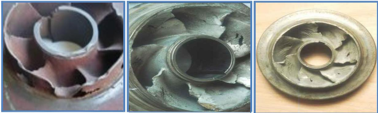
**Figure VI.5** - Les problèmes causés par le phénomène de cavitation sur les aubes d'une pompe centrifuge.
