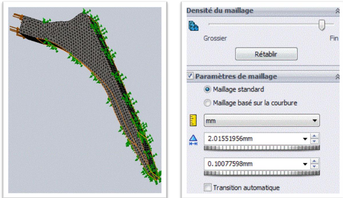
Figure.III.7 : Création du maillage type standard de la tige fémorale, à droite de la figure les caractéristiques du réglage du maillage sur le logiciel Solid-Works 2012.
